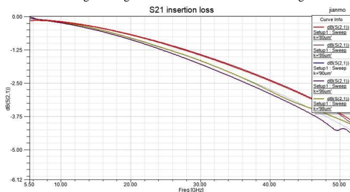
图 8 “开启”时悬臂梁长度改变对插入损耗的影响
