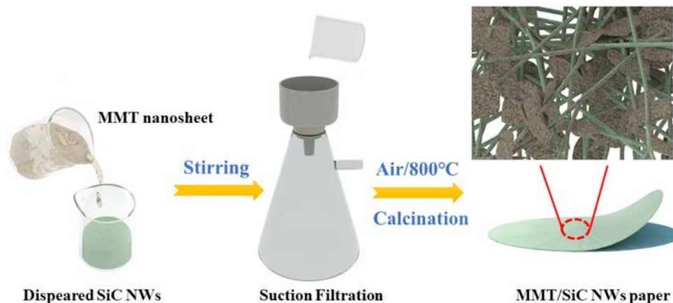
图 1 蒙脱土/SiC 纳米纤维陶瓷纸制备过程示意图
