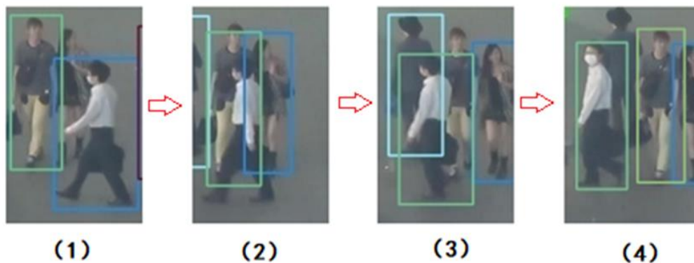
图 2 现有跟踪算法在复杂场景下发生误匹配的情况。在图中,蓝色目标框原本属于一位男士,使用常规方法进行跟踪之后,蓝色目标框传递到了一位女士身上,发生了 ID 跳变的情况。
