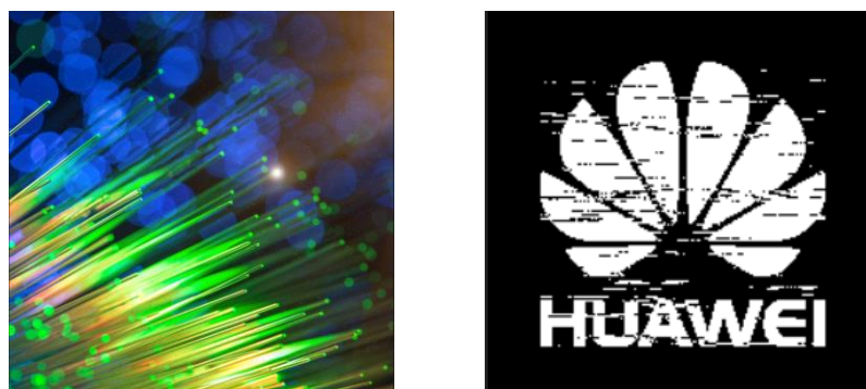
图 3-20 版本 3 加入方差 0.005 椒盐噪声后所提取水印
