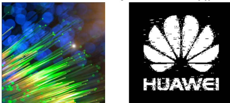
图 3-21 版本 3 加入方差 0.0006 高斯噪声后所提取水印
