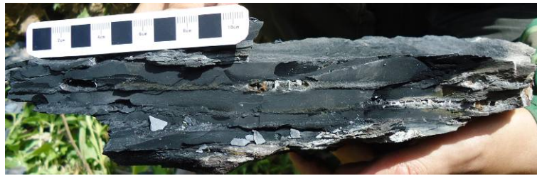
a)小内冲组碳质泥岩中黄铁矿条带及磷结核
