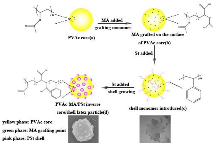
图 6 PVAc-MA/PS 反向异形核壳结构乳胶粒形成机制
