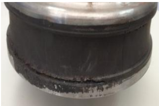
(b) 支座真实疲劳裂纹位置
