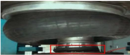
图 7 橡胶支座的疲劳试验
